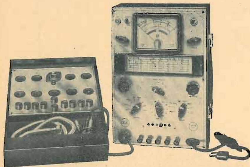
Oscillatore - Misuratore Universale - Provavalvole Mod. 106
